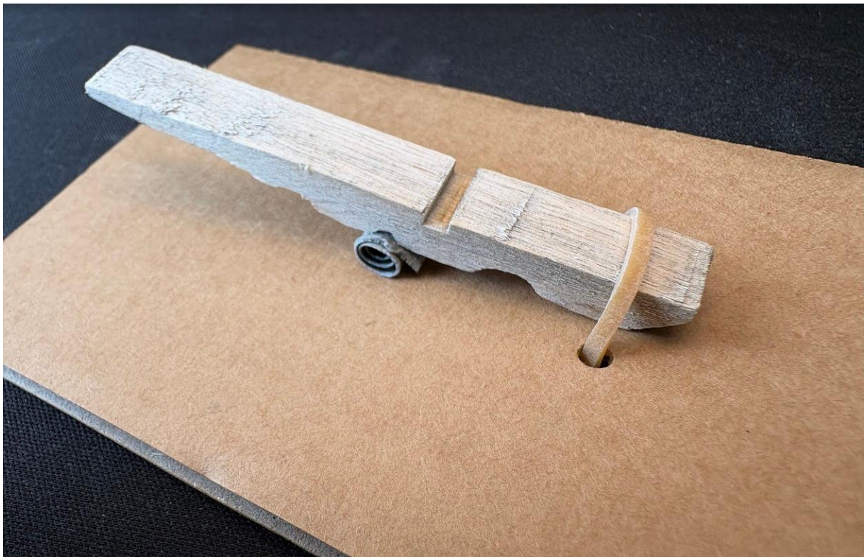
Figur 6: Klypen festet med strikk som går gjennom hullene. Kilde: Andøya Space
