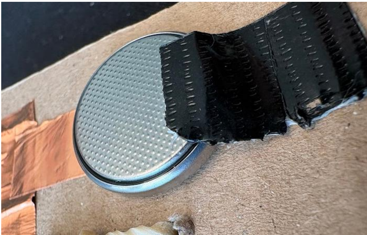
Figur 11: En tapebit holder batteriet nede med rom for å koble til på minussiden. Kilde: Andøya Space
