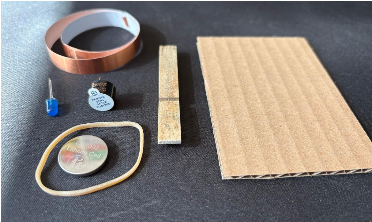
Figur 3: Delene som trengs for å lage morsesenderen. Kilde: Andøya Space
