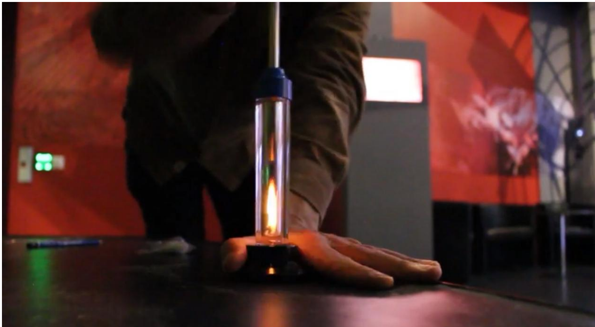
Figur 2: Demonstrasjon av en luftkompresjonsenhet der raskt trykk øker temperaturen i sylindere, og luften blir så varm at den antenner materialet inni. Kilde: Andøya Space
