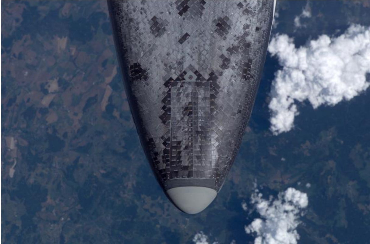
Figur 3: Varmeskjold på romfergen discovery, tatt fra den internasjonale romstasjonen. Kilde: NASA
